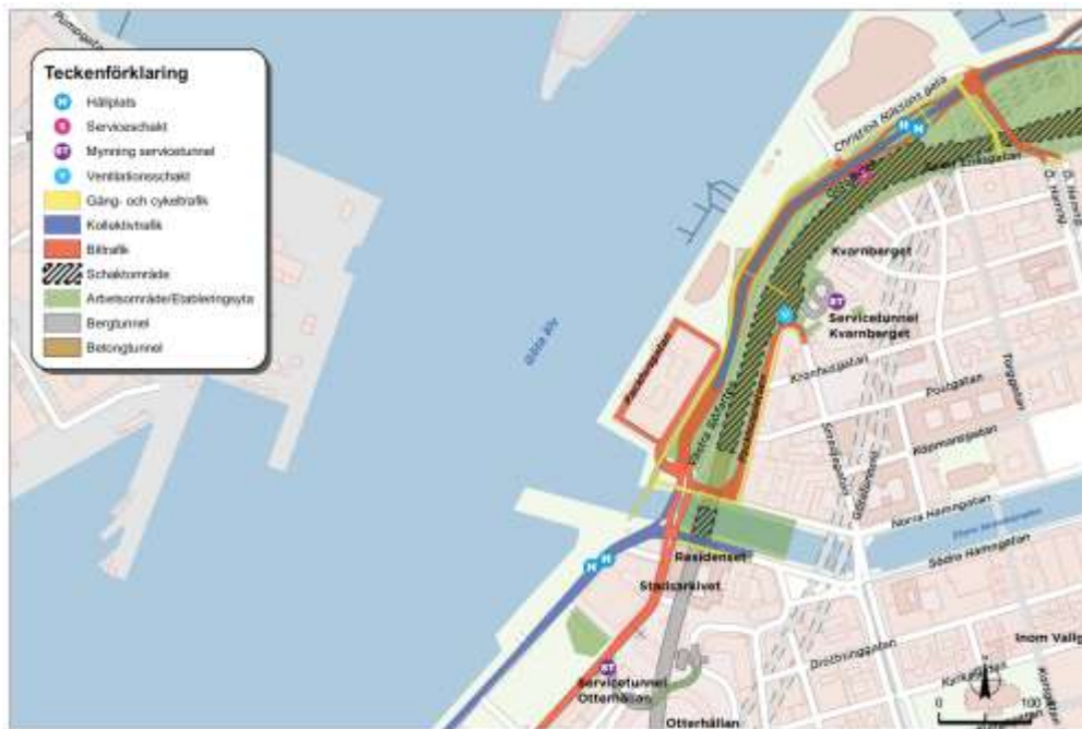
FIGUR 1.13. Översikt över arbetet mellan Station Centralen och Residenset. Arbetet delas upp i flera mindre schakter som utförs samtidigt.
